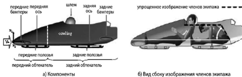
Рисунок 1. Компоненты боба и изображение экипажа
