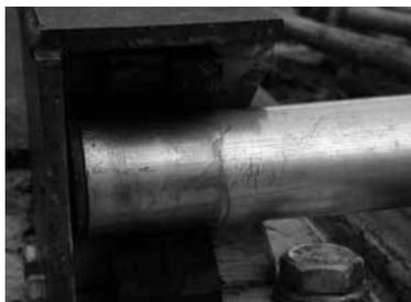
*Рисунок 9. Улавливающая труба внутри модифицированного опорного блока*
