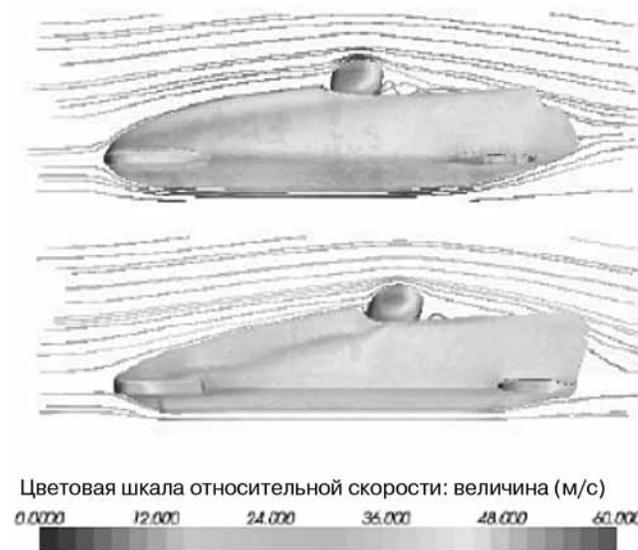
Рисунок 4. Изокоординаты относительной скорости и линии обтекания, рассчитанные для исходной формы боба (вверху) и модифицированной формы (внизу). В обоих случаях высота от стенки дна равна 70 мм.
