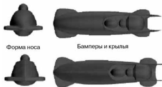
Рисунок 3. Альтернативная конструкция боба: исходная форма боба (вверху) и форма боба после модификации носового конуса (внизу)
