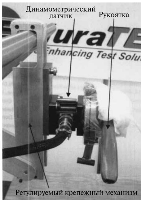
Рисунок 3. Динамометрический датчик и рукоятка толкания боба
