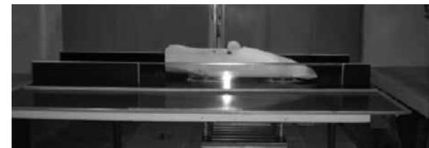
Рисунок 6. Модель, испытываемая в аэродинамической трубе, и боковые панели, установленные в измерительной части аэродинамической трубы
