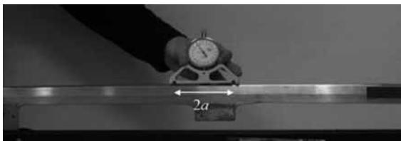
Рисунок 2. Один из этапов сбора данных на полозе бобслейных саней
