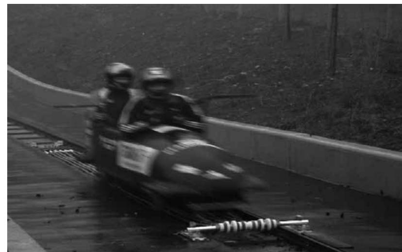
Рисунок 5. Боб-двойка до захвата улавливающей трубы
