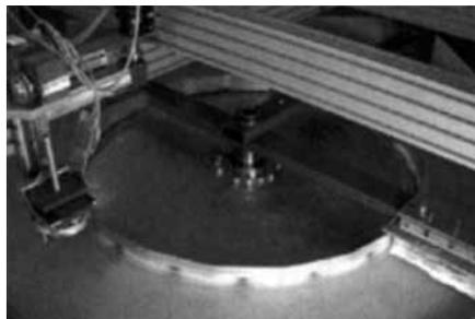
Рисунок 1. Испытательный стенд Tribo Disc
