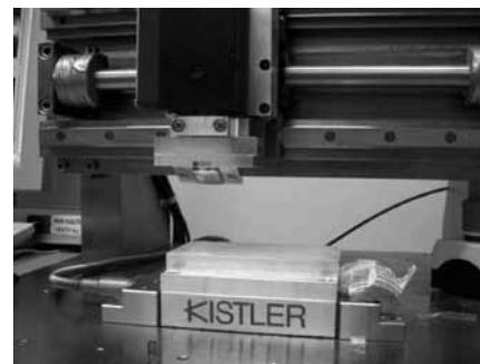
Рисунок 2. Прибор для измерения ударного трения, применяемый для измерения трения и глубины проникновения полозьев саней внутрь льда
