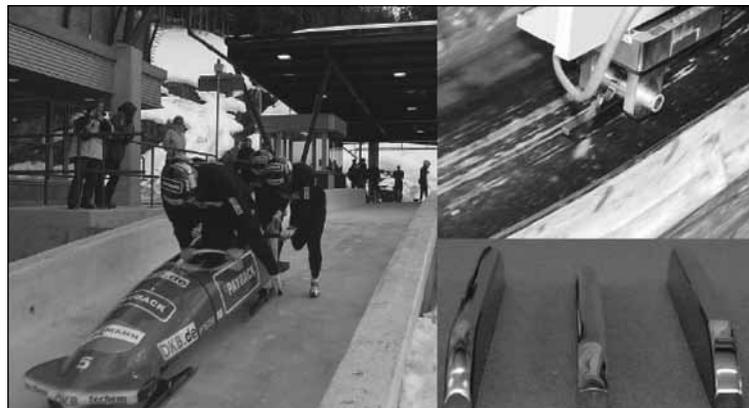
*Рисунок 1. Вверху справа измерительное устройство с полозом и датчиком в ледяном канале; внизу справа разные типы полозьев: (слева направо) для боба, скелетона и тобоггана (© Fraunhofer IWM)*
