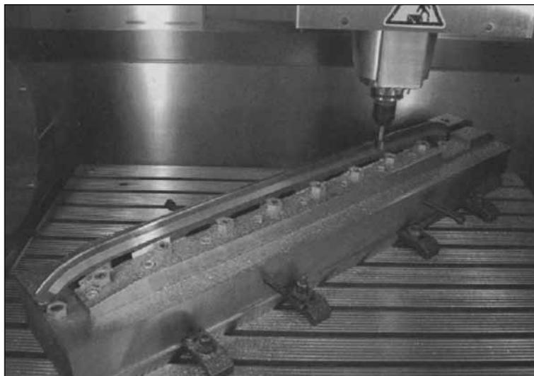
Рисунок. 2. Изготовление полоза для бобслейных саней на фрезерном станке
