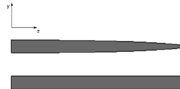
Рисунок 29. Полоз боба (вверху) имеет вытянутую полуэллиптическую контактную поверхность со льдом, в то время как контактная поверхность лезвия конькобежного конька со льдом (внизу) имеет прямоугольную форму (изображения отпечатков выполнены без соблюдения масштаба)
