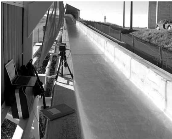
Рисунок 49. Применение радарной установки в ходе предварительных испытаний (снимок сделан от входа в поворот 4 и содержит изображение выхода из поворота 3; радар расположен на низкой стенке желоба и подсоединен к компьютеру для сбора данных; при проведении заездов на кубок мира по просьбе организаторов соревнований радары крепились к наружным конструкциям трассы, чтобы они не могли упасть вовнутрь желоба)
